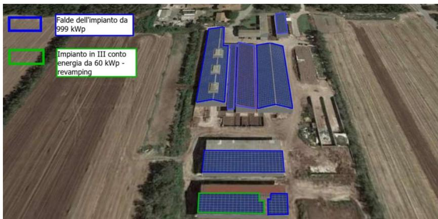
Nel corso del 2023, il settore produzione ha avviato la valutazione per l'acquisto di un progetto di **realizzazione di un impianto fotovoltaico da 999 kWp sui tetti di un'azienda agricola**, nel territorio di Arborea (OR), facente parte del Consorzio Arborea Latte. La proposta di acquisto è giunta dalla società Clere Italia 2 S.r.l.
